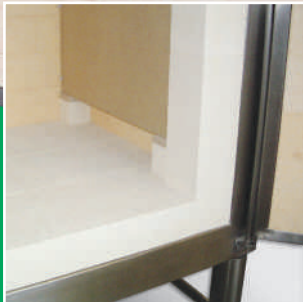
Feuerleichtstein ASTM 26 in stark beanspruchten Regionen fire brick ASTM 26 in strongly claimed regions
